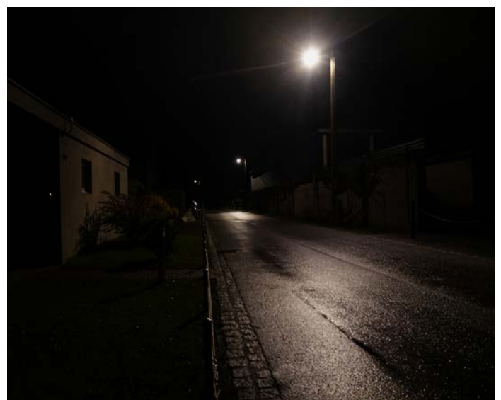
Die Gemeinde Fläsch GR dimmt in der Nacht die Strassenbeleuchtung. Die Bilder zeigen die Situation am späten Abend (li.) und nach Mitternacht (re.), wobei die Lichtstärke dann noch acht Prozent der Vollbeleuchtung beträgt.
